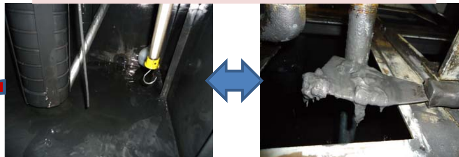
研磨機のタンク内(砥粒/超鋼カスが堆積)
