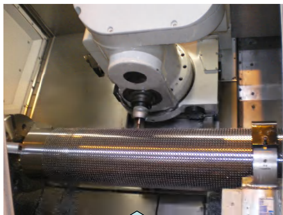
MAZAK-NEXUS200-IIによる穴あけ加工
